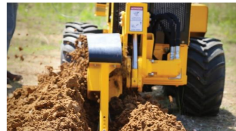
トレンチ作業に特化したパワーユニット
