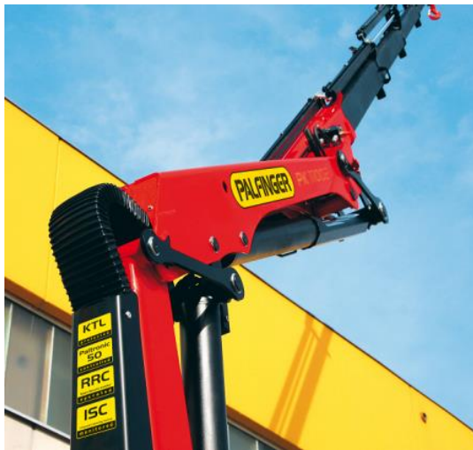
パワーリンクプラス アウターブーム逆折れ機構は、 PK8502以上のモデルで採用されています。
