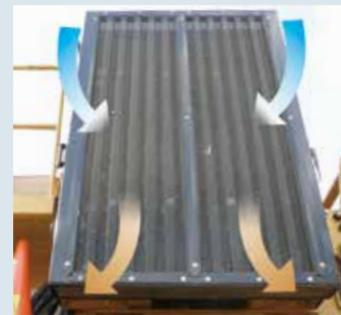
大型ラジエータの搭載と、冷却空気を吸込みから吐出しに任意の設定で切り換えられるので、細かいチップを排出してラジエータの目詰まりを防ぎます。
