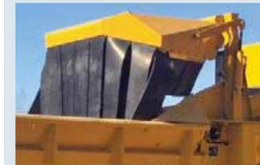
リモートコントロール操作で開閉が自由にでき、粉碎時の材料飛散を最小限にします。
