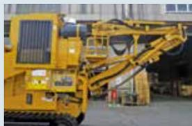
折り畳み式ロングコンベヤ(オプション)により、より高くチップを排出できるようになりました。トラック直積みにも対応でき、エンジン式・電動式の全機種で折り畳み式ロングコンベヤのラインナップがあります。
