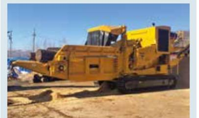
生産量が最大になるようにフィードローラーが材料を押さえつけて各部連動し、粉碎します。
