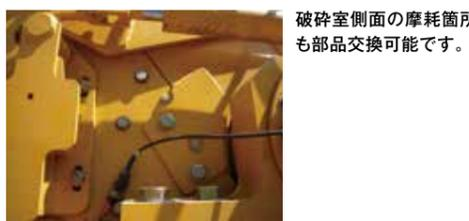
破砕室側面の摩耗箇所も部品交換可能です。
