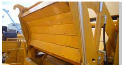
破砕室内部の摩耗箇所が部品交換可能です。メンテナンスに必要な時間が短縮され整備時間が削減されます。
