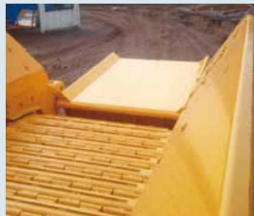
チップー用1.5m延長テーブル。4mの丸太を落とさず投入することが可能で、運搬時は折りたむことができます。
