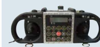
オペレーターは稼働中の様々なエンジン情報を確認しながら効率のよい作業が行えます。また、緊急時のために非常停止装置も装備しています。
