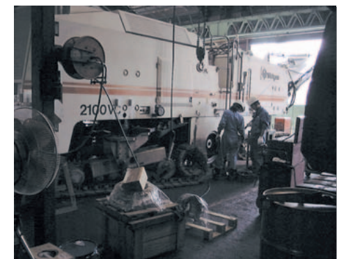
大型道路切削機の修理
