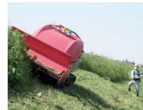
35度の斜面でも安全作業が可能な有人・無人対応型草刈機
