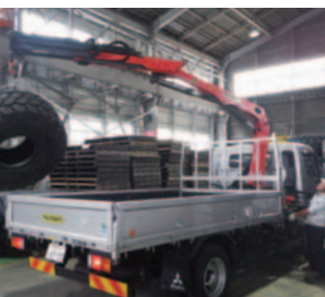
パルフィンガークレーン／エプシロンクレーン トラック積載型の屈曲式ローダークレーンはブーム先端にあるフックで直接荷を吊り上げる構造により、荷を素早く移動させられるという特長があります。また、フックの代わりにグラップルを付け、木材や金属スクラップをハンドリングする専用機としても広く利用されています。
