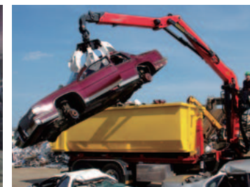
パルフィンガークレーン／エプシロンクレーン トラック積載型の屈曲式ローダークレーンはブーム先端にあるフックで直接荷を吊り上げる構造により、荷を素早く移動させられるという特長があります。また、フックの代わりにグラップルを付け、木材や金属スクラップをハンドリングする専用機としても広く利用されています。
