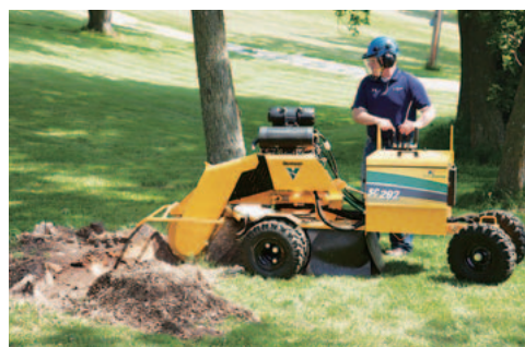
スタンプカッター ゴルフ場、公園、街路樹等の造成工事で発生した切り株を5分で簡単に切削処理できます。
