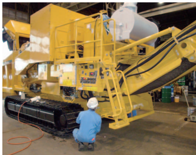
木質系破砕機の整備 稼動時間に応じて入念に整備を行います。お客さまの立場に立って安全対策、強化対策も実施します。
