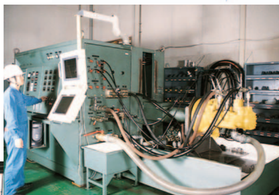
油圧シリンダーの再生 高トルクのシリンダーリベアスタンドを用いて、大型シリンダーのオーバーホールを実施します。また整備後は豊富なテスト機器を使用して万全を期します。
