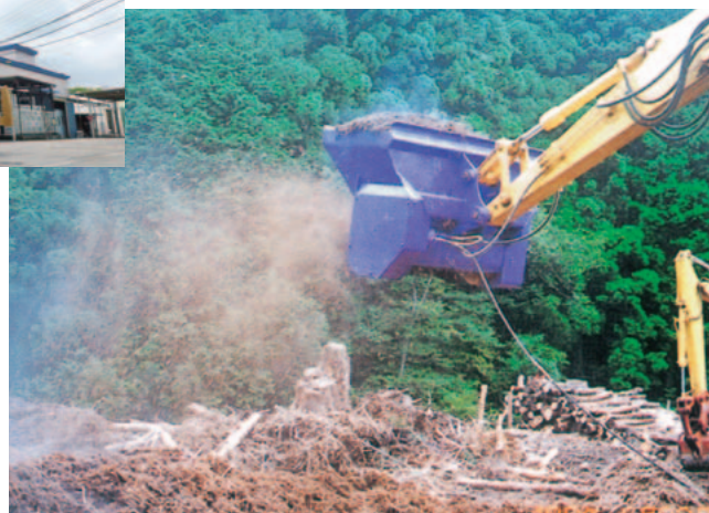
チップ散布機 チップをマルチング材として吹き付ける作業や、ゴルフ場の目砂散布、果樹園や農園の堆肥の散布・切り返し等が効率良く行えます。
