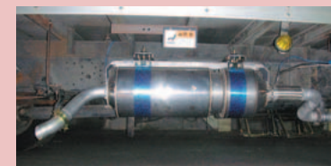
「スモークバスターNシリーズ」 国土交通省の認定を受けた自動車NOx・PM法対応装置 自動車NOx・PM法に適合しないため、車検の継続ができない車両を、本装置を装着することにより車検を可能にする装置です。
