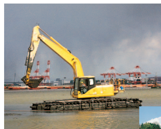
泥上作業機 河川・干潟・沼地・超湿地などの軟弱地盤での土木作業に威力を発揮します。
